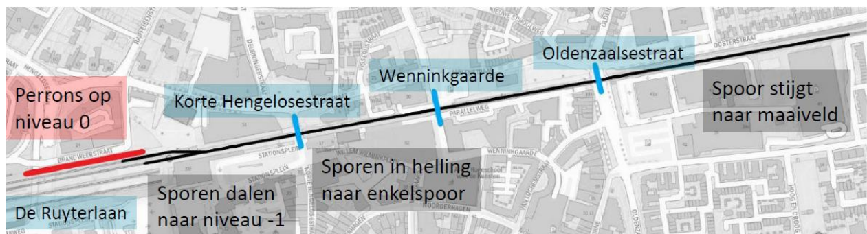
Abbildung 16: Alternative 2: Einzeltunnel und Bahnsteige auf heutigem Niveau
